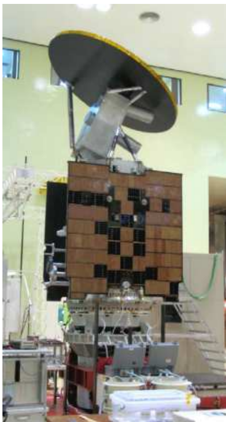
Fig. 14: EQM montado en el modelo estructural del SAC-D en el LIT-INPE (Brasil), durante la campaña de calificación.
